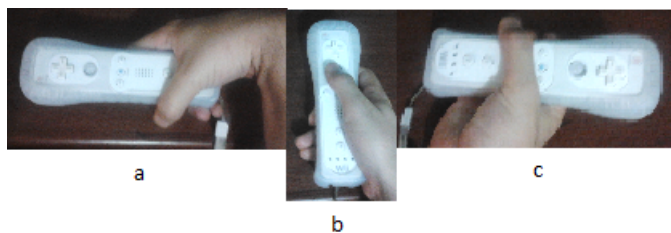
Fig. 6. rotación del modelo en el eje Z, a) rotación en dirección positiva, b) posición neutra, c) rotación en dirección negativa
